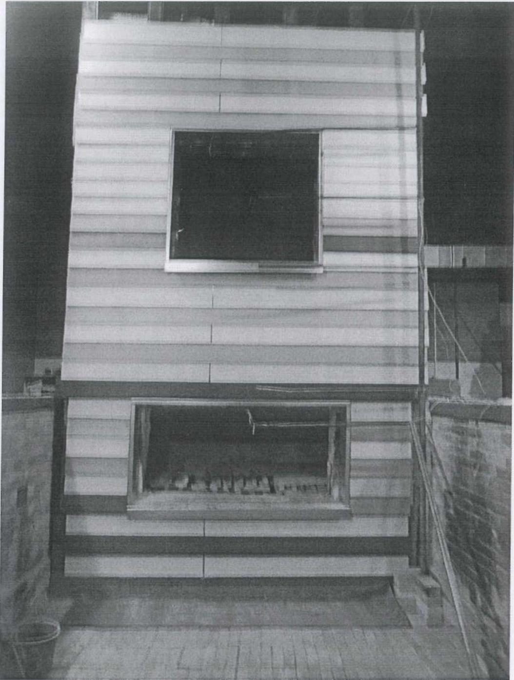
Фото 1. Фрагменты образца фасада до испытания по ГОСТ 31251-2008.
