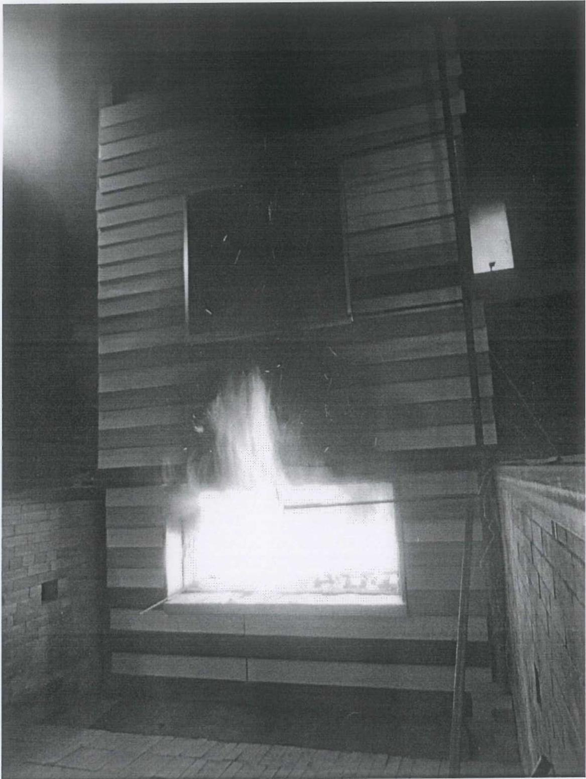
Фото 2. Фрагменты образца фасада при испытании по ГОСТ 31251-2008.
