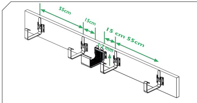
2. Для обеспечения хорошего сцепления дна желоба с уплотнителем, поднимите соединитель примерно на 1–2 мм относительно уровня соседних соединителей.
