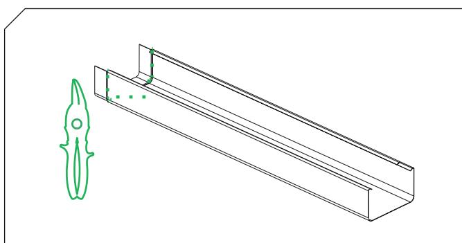
3. Ножницами по металлу вырежьте рельефную часть желоба, с той стороны, которая будет размещена в соединителе.
