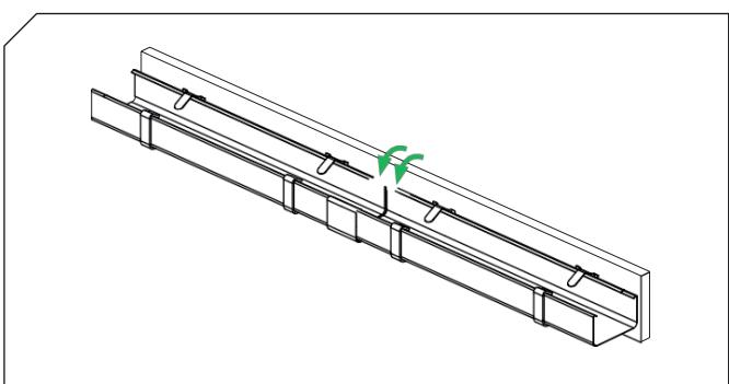
7. Загните крепежные пластины соединителя.
