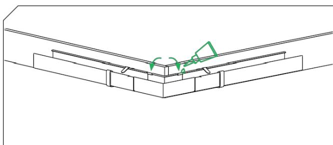
5. Загните капельники на желобах. Закрепите соединение изнутри герметизирующим kleем.
