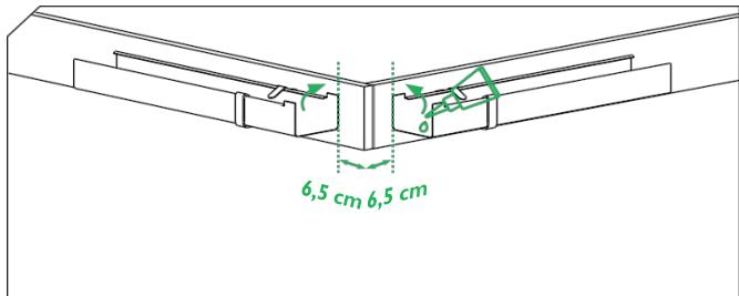
3. Положите предварительно вырезанный желоб вертикально. Нанесите на место размещения угла две полоски kleя-герметика.
