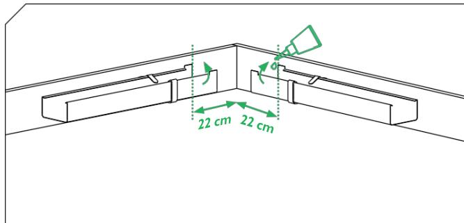
3. Положите предварительно вырезанный желоб вертикально. Нанесите на место размещения угла две полоски клея-герметика (1,5 см от края желоба)
