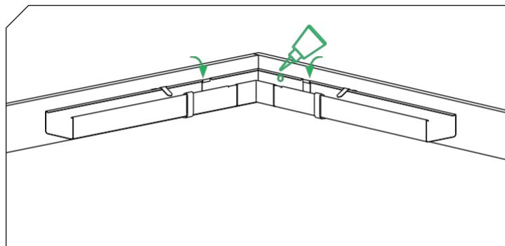
5. Загните капельники на желобах. Закрепите соединение изнутри герметизирующим kleем.
