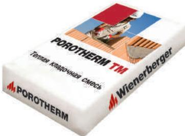
Мы рекомендуем для кладки блоков Porotherm использовать тёплый раствор Porotherm TM, специально разработанный для поризованных блоков с целью снижения теплопотерь через растворные швы. Как известно, при использовании обычного раствора через швы уходит порядка 15% тепла, чтобы минимизировать теплопотери, используется тёплый кладочный раствор.
