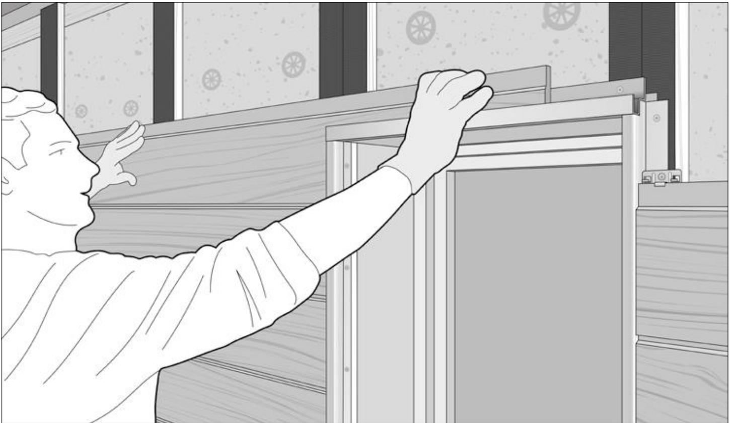
Продолжайте монтаж. Для монтажа доски над окном расчертите контур верха окна на задней стороне доски, и обрежьте ее с помощью электролобзика. Убедитесь в том, что доска установлена над окном на одном уровне с другими досками в ряду, затем закрепите ее с помощью клеймера и самореза.
