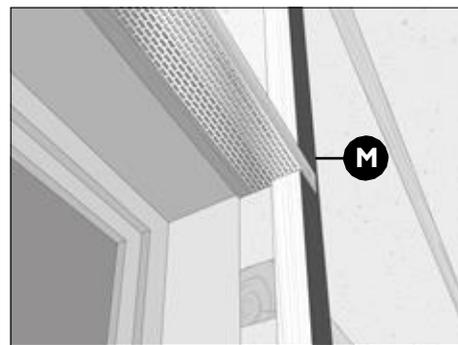
Чтобы предотвратить попадание грызунов и птиц в вентилируемый зазор, установите перфорированные вентиляционные профили по периметру фасада над оконными и дверными проёмами. Убедитесь в том, что защищен любой зазор шире 25 мм.
