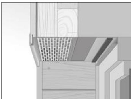
Измерьте глубину оконного откоса, не забывая о 25-мм зазоре, для вентиляции. Отпилите необходимую полосу фиброцементного сайдинга в продольном направлении
