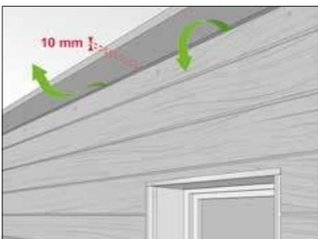
Отрежьте верх последней доски в продольном направлении до необходимой высоты, сохраняя минимальный зазор 10-мм между фасадом и кровельным свесом.
