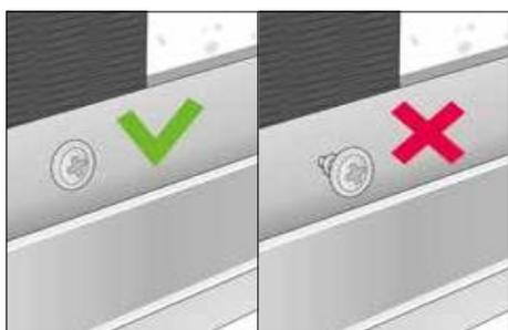
Используйте саморезы из нержавеющей стали для крепления профиля. Убедитесь, что шляпки установлены заподлицо с поверхностью профиля.
