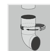
8. Установите водосточный слив на трубу и зафиксируйте его хомутом.
