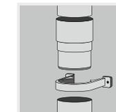
7. Соединение водосточных труб между собой производится при помощи муфты, которая фиксируется на фасаде при помощи хомутов.
