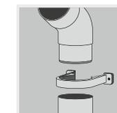
6. Водосточные трубы крепятся к основанию здания при помощи хомута крепления трубы. На каждый элемент трубы длиной 3 м или 1,5 м устанавливается не менее двух хомутов. В ассортименте водосточной системы существует еще один вид крепления — «хомут универсальный», который позволяет крепить водосточные трубы на требуемом для вас расстоянии на любые виды фасадов.
