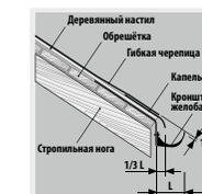
1. Желоб должен опускаться при длине 1 м на 3,5 мм.
