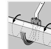
4. Установите водосточные желоба в кронштейны согласно рисунку до защелкивания с фиксирующим элементом кронштейна.
