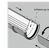
5. Вставьте желоб в соединитель желоба до обозначенной линии. Соединение желоба с соединителем желоба необходимо производить в направлении «изнутри-наружу»: от внутренней стороны желоба (от фасада здания) к внешней до защелкивания с фиксирующим элементом желоба.
