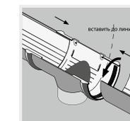
2. Вставьте желоб внутрь воронки до обозначенной линии. Соединение желоба с воронкой необходимо производить в направлении «изнутри-наружу»: от внутренней стороны желоба (от фасада здания) к внешней до защелкивания с фиксирующим элементом воронки.
