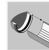
3. Установите желоб в заглушку до защелкивания с фиксирующим элементом заглушки.
