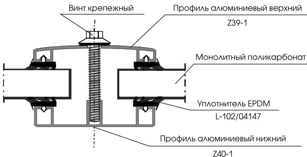
**Рис. 3. Крепление конькового элемента**
