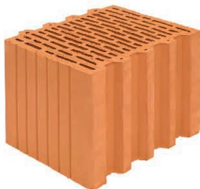
Porotherm 30 – крупноформатный блок для строительства внутренних несущих стен. Высокая прочность блоков (M200) позволяет использовать при строительстве зданий высотой до 10 этажей. Толщина стены, построенной из блоков Porotherm 30, составит 300 мм. Высокий уровень звукоизоляции обеспечивает защиту от шума между прилегающими помещениями.
