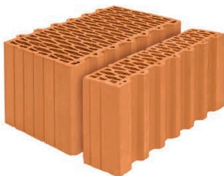
Porotherm 44 применяется для строительства зданий с несущими стенами до 8 этажей без дополнительного усиления кладки. Также данный блок используют для заполнения монолитного каркаса.
