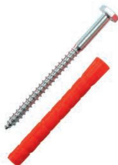
TOX Vizeps – анкерное решение для крепежа металлических конструкций, элементов из дерева, раковин, бойлеров, радиаторов, опорных консолей, обладающее высокой несущей способностью в пустотелых строительных материалах. TOX Vizeps отличаются уникальной объёмной системой с удлинённой зоной распора в 90 мм, что позволяет крепить к стене элементы весом до 70 кг на точку крепления (разрушающая нагрузка до 500 кг).
