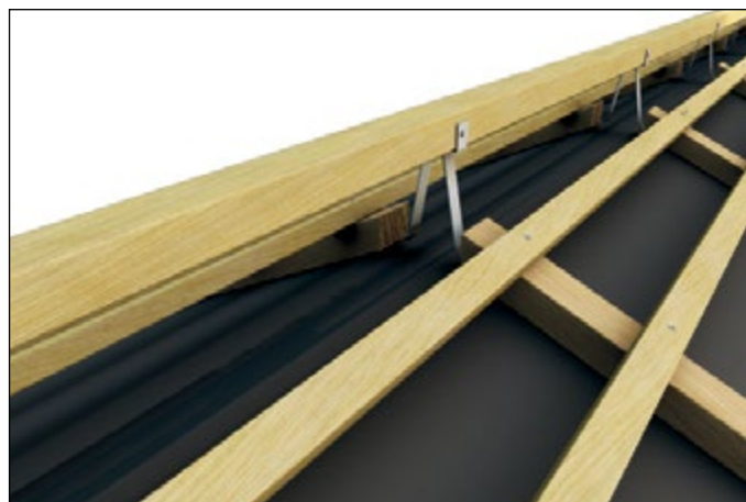
Вариант 1: Коньковый брус — монтаж с коньковыми кронштейнами
