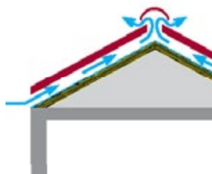
ТЕПЛАЯ КРЫША С небольшим или отсутствующим пространством над изоляцией на скатной кровле.
