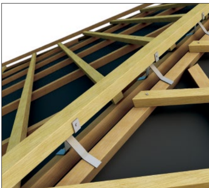
Вариант 1: Вальмовый брус — монтаж с коньковыми кронштейнами
