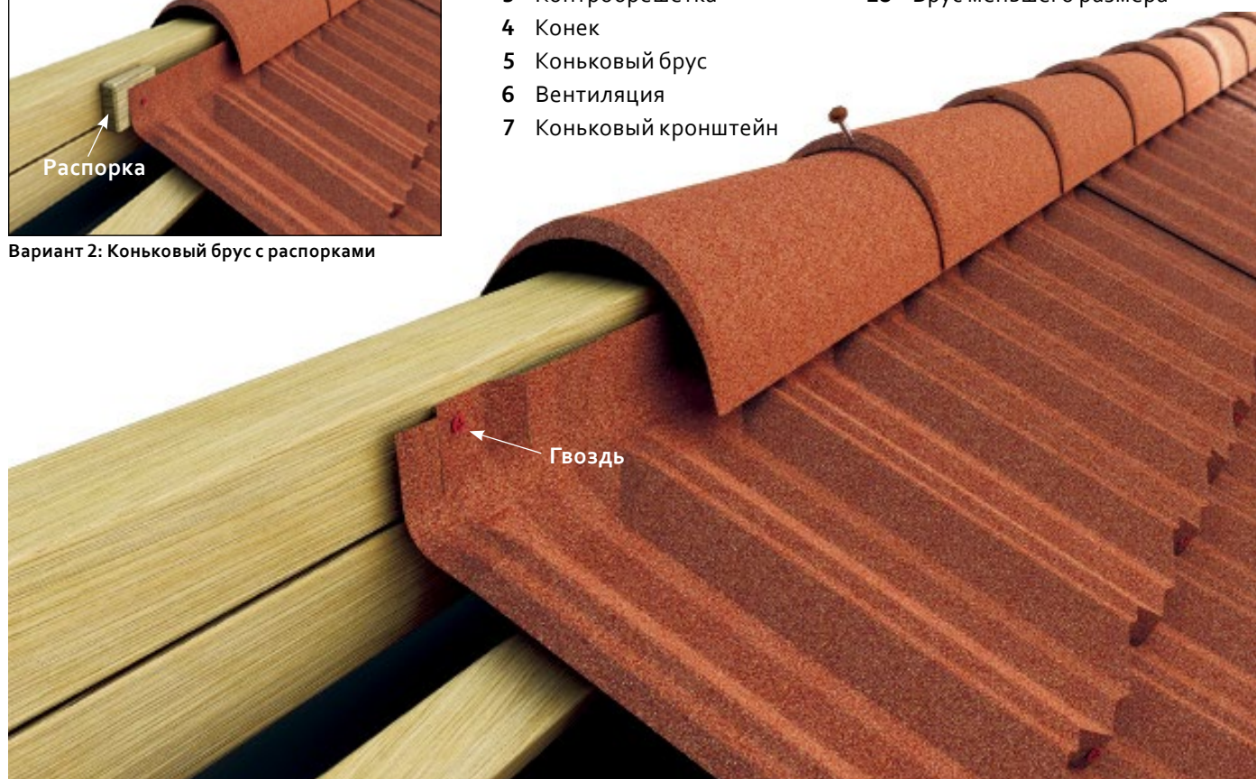
Вариант 1: Коньковый брус с вентиляционным отверстием
